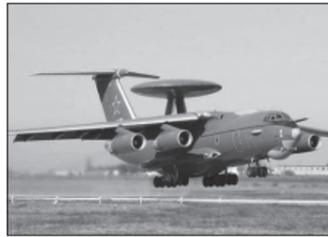
Свой первый полет совершил новый российский самолет дальнего радиолокационного дозора А-100 «Премьер». Он создан на базе военно-транспортного самолета Ил-76МД-90А и оборудован цифровым навигационным комплексом, а также новым локатором.
